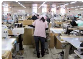
村岡工場・西部工場にある「一枚流し立ちミシン」。右手前→奥→左手前と、逆U字ラインで縫っていく(西部工場)
